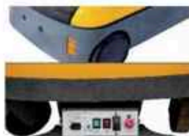
地面控制面板 Floor Control Panel
